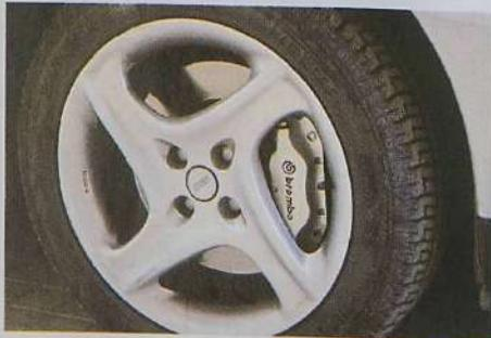
Μιλάμε για τα φρένα: αεριζόμενοι δίσκοι με διάμετρο πάνω από 30 εκατοστά, αλουμινένιες δαγκάνες με 4 εμβολάκια... και το λογότυπο της Brembo.
